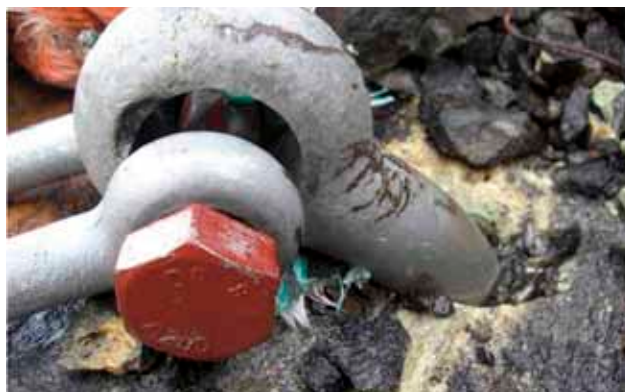
Figur 15 Bøyd fjellbolt (Foto: Noomas Sertifisering).
