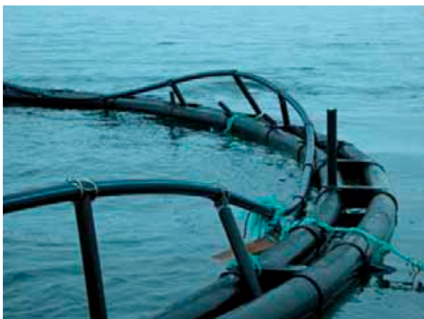
Figur 2 Skade på rekkestøtter og klammer etter at plas-tanlegg har vært nediset (foto fra Barlinthaug NORFICO).
